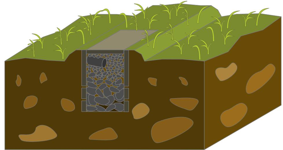
*Un type de puisard possible. L'eau qui rentre par le haut est généralement diffusée par des trous dans les parois ou par le bas du puisard. Des modèles basiques avec des matériaux naturels peuvent être très efficaces également (Voir le schéma avec une tranchée remplie de cailloux dans la partie « [VII.2.3.drainage](#) »).*
