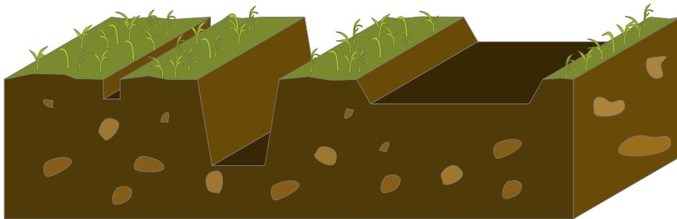
*De gauche à droite, une rigole peu profonde pour des débits faibles à modérés. Un fossé, le plus souvent en bordure de terrain pour des débits forts. Enfin, une noue (ou baissière) est creusée généralement perpendiculairement à la pente d'un sol.*
