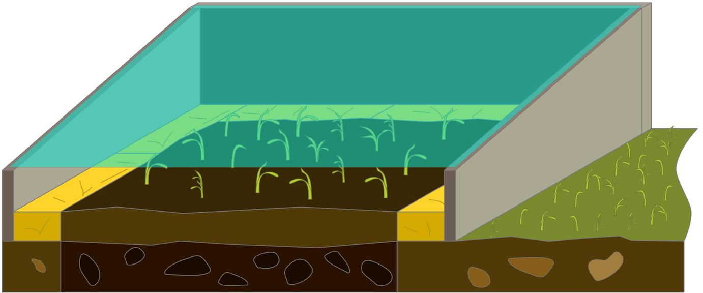
*Vue en coupe d'une mini-serre remplie d'une couche chaude enterrée et de terreau isolé par de la paille. Effet de serre par une vitre située au-dessus.*
