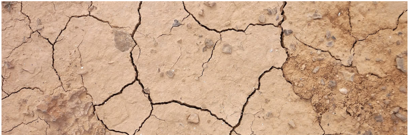
Croûte de battance de limon sur un sol. Photo de Tiia Monto sous licence Creative Commons BY-SA. La couche de limon est fine, contrairement à de l'argile sèche qui se rétracte et dont l'aspect peut être similaire à première vue.
