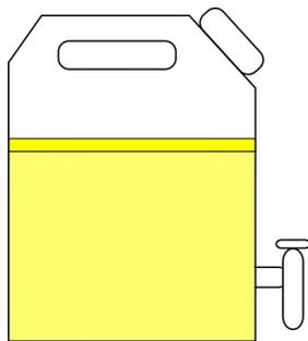
*Un séparateur d'urine aide à une gestion plus simple. L'urine est réutilisable de suite. Un ajout d'huile bloquera les échanges avec l'air et les odeurs. Un robinet permet de récupérer l'urine.*
